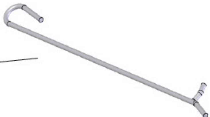
Pour contrôler visuellement la flamme du brûleur pilote, retirez la plaque centrale à l'aide du crochet prévu à cet effet.
